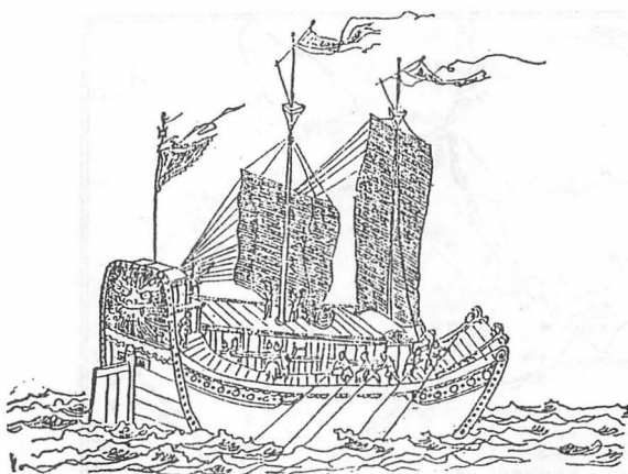
图 3-4-2(甲) 元代海運漕船——漕船 (据: 王洸著《中华水运史》及《水运技术词典》绘)
